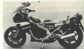
Ett kraftigt rambygge i aluminium. Notera luftfilterboxen bakom styrhuvudet. Där finns kall insugsluft som ger effektivare förbränning.
