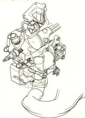
Hondas system med extra avgaskammare kallas ATAC. De sitter emellertid bara på det främre cylinderparet.
