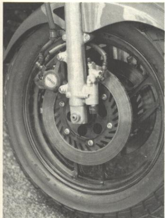
De dubbelverkande oken och 267 mm skivorna är inte lika kontrollerbara vid hård inbromsning som övrigas bromsutrustning.
