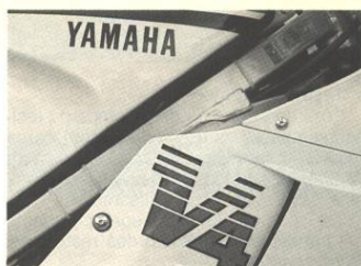
Kåpan sitter med många skruvar och är pillrig att få bort.
