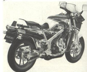
Ett stadigt rambygge i fyrkantsprofiler av aluminium. Framgaffeln är avancerad med tre olika justeringsmöjligheter, bak finns dock bara förspänningsjustering.
