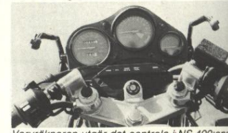
Varvråknaren utgör det centrala i NS 400:ans instrumentering. Det matta glasat kan ge reflexer som stör avläsningen.
