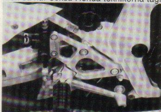
Förspänningen av bakhjädern sker hydrauliskt. Stötdämparen är hård redan i grunden och det mjukaste laget fungerar bäst.
