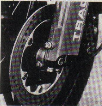
Verkligen häftiga bromsar. Dubbelkolvsocken och 256 mm skivorna är oerhört effektiva. Antidiveverkan är justerbar i fyra lägen och framgaffeln är inklädd för att minska luftmotståndet.
