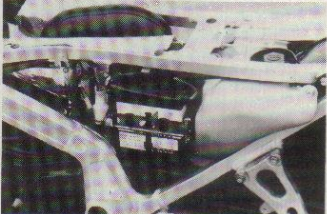
Ett litet 4 Ah-batteri ger reserv för elförsörjningen. Påfyllning av tvåtaktsolja för separat-smörjningen sker under sadeln.
