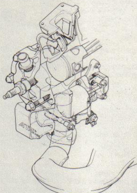
Hondas recept för bättre mellanregistereffekt heter ATAC. En extra kammare öppnas på lågvarv så att avgassystemet stäms av bättre. Enbart de två främre cylindrarna har systemet.
